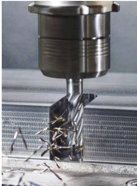
*Darf in den Tool-O-Maten bei der Firma Recker nicht fehlen: Der CCR-Fräser aus der WNT-Performance Linie von Ceratizit ist die erste Wahl für trochoidale Fräsbearbeitungen. Bild: Ceratizit*
